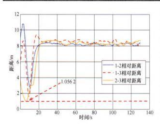
摘要:针对多无人机系统利用有限时间环形编队算法执行环形编队任务时易发生碰撞这一问题,提出一种基于改进人工势场法的多无人机有限时间环形编队控制算法,引入一组与障碍物移动方向垂直的辅助势场,避免了多无人机在快速编队过程中发生内部碰撞,并解决了传统人工势场法易陷入局部最优解的问题。为验证本文算法的有效性,在无人机初始位置、势场影响范围、包围半径等参数相同的情况下进行计算机仿真实验,结果表明算法可有效地避免多无人机在环形编队过程中发生碰撞的问题。为进一步验证算法的实用性,采用三架轴距 450 mm 的"X型"旋翼无人机进行物理实验,实验结果表明本文算法在有限时间内完成多无人机环形编队时具有较好的避碰效果。
