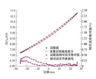
摘要:提出了一种考虑等效阻尼及滞回特性的乘用车用空气弹簧动刚度模型,给出模型中各部件物理意义及数学表达以适用于空气悬架的精确控制。基于模型解析表达式给出一套针对模型中有效面积等效刚度、空气气囊刚度和等效阻尼等关键非线性参数辨识的一般方法,设计示功试验对各参数项进行辨识并验证了在大行程下动刚度模型及参数辨识方法的正确性和可行性(大行程正弦激励下模型最大相对误差小于0.5%,参数辨识误差小于3%)。最后基于推导出的动刚度模型分析了关键参数的影响及其动态特性。结果显示,乘用车单腔室空气弹簧的滞回特性(相位角)随频率增大呈现先增大后减小的趋势。等效刚度越大相位角峰值越大且对应频率越高;等效阻尼越大相位角峰值不变,对应频率减小。根据理论和试验指明了空气弹簧关键非线性参数的频率相关性及其变化规律,为空气弹簧的理论建模及正向开发提供指导。
