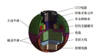
摘要:为了实现食管、胃、结肠等宽裕环境内诊断与治疗,双半球胶囊机器人需要实现稳定的滚动行走。为了探究旋转磁场强度、旋转速度、阻尼等参数对胶囊滚动动态性能的影响,确定胶囊姿态角变化范围,结合旋转磁场随动效应建立了双半球胶囊拉格朗日滚动动力学模型,采用区间状态转移矩阵逼近算法求得状态转移矩阵,通过分析状态转移矩阵特征指数,确定了能够实现稳定滚动的临界和最优控制参数。提出了基于激光系统的胶囊滚动姿态检测方法,模型仿真与试验结果表明:在一定范围内,磁场强度的减小及磁场旋转角速度的增加通常有利于机器人滚动动态稳定性的增强,该动力学特性为控制胶囊实现肠道内稳定滚动控制策略提供了理论依据。
