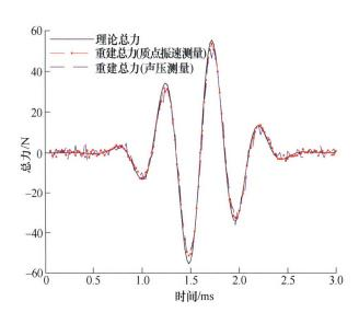
摘要:基于质点振速测量重建了作用于薄板表面的瞬态力。首先根据薄板的运动方程推导了板表面上力谱与振动速度谱之间的脉冲响应函数,再联立板表面上振动速度谱和全息面上质点振速谱之间的脉冲响应函数,在波数域-时域中构建了力谱和质点振速谱之间的传递关系:在此基础上,以全息面上测量的质点振速作为输入,重建出了每一个波数点处的力谱,并通过对力谱作空间Fourier逆变换得到了板表面上的瞬态力。数值仿真和实验结果验证了基于质点振速测量重建瞬态力方法的可行性和有效性,它不仅能定位出激振力的位置,而且可以重建出力的时间历程。同时,与现有的基于声压测量的重建方法相比,本文方法可以获得相似的重建精度,但重建过程更简单。该方法提供了一种实时、非接触式的测量方式来获取薄板所受的瞬态力,且建立的力理。辐射间的直接联系有助于进一步探索噪声产生的机理。
