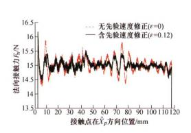
摘要:在机器人曲面磨抛过程中,当末端工具与工件曲面相对运动时,控制机器人运动使二者间的接触力保持在某个恒定期望值,对于曲面磨抛的质量控制具有重要的作用,对于进一步展开机器人磨抛工艺研究也具有积极的意义。针对过去力信号难以及时补偿将来轮廓变化而导致法向接触力不平稳的问题,提出一种基于力反馈和先验轮廓倾角的柔顺控制方法。首先基于阻抗控制方程建立机器人曲面跟踪柔顺接触模型,引入法向控制速度,推导出其与力反馈信息间的映射关系。同时,设计在线轨迹生成器,利用先验轮廓倾角计算法向先验速度,并对法向控制速度进行实时修正。最后将所提方法运用至机器人曲面跟踪物理实验,实验结果表明,该方法相比无先验速度修正的柔顺控制,能有效避免凸面/凹面区域下法向接触力震荡,力方差减小55%以上。
