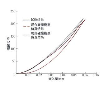
摘要:目前广泛采用的接触碰撞建模方法主要基于传统的物理碰撞模型,如赫兹碰撞模型和非线性弹簧阻尼碰撞模型等,但它们的仿真精度不够高,更适用于接触碰撞趋势的仿真分析。基于此,提出了基于传统物理碰撞模型和数据驱动误差模型的混合碰撞建模方法,以更加准确地对接触碰撞现象进行动力学仿真分析。其中,物理碰撞模型对接触碰撞现象中已知的碰撞因素进行建模;基于径向基函数(Radial basis function,RBF)神经网络的数据驱动误差模型对接触碰撞现象中的误差部分进行建模。小球自由落体碰撞试验对混合碰撞建模方法的可行性和混合碰撞模型的准确性。
