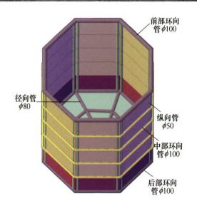
摘要:随着人类对太空的逐步探索,大尺度空间可展开结构的应用日益广泛,对高收纳比的需求日益迫切。面向在轨舱体需求设计圆柱形可展柔性结构,结合折纸技术提出了两阶段、多维度的结构折展方案。针对高收纳比的技术要求,设计的可展柔性结构先执行平面内径向折展,后执行空间纵向折展,该折展方案的收纳比可达到 98.6%。基于一阶基频的需求,对可展柔性结构的模态进行参数化分析,讨论充气管气压和膜面预应力的影响。采用有限元分析软件 ABAQUS对结构的两阶段展开过程进行了动力学分析,验证了展开过程的平稳有序,形态变化与受力皆合理,证明了结构设计方案的可行性与合理性。最后,使用薄膜褶皱参数的通用计算流程对展开后的褶皱构形特征进行了估算,并预测了对应位置上的褶皱构形。
