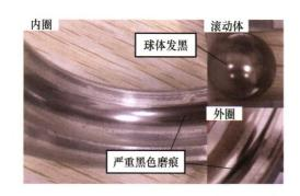
摘要:液体火箭发动机高速涡轮泵的起动是在高压、低温等极端工况下的典型瞬态起动,极易导致其支承轴承的失效。本文构建了低温滚动轴承全液膜润滑和起动摩擦力矩的求解模型,获得了在特定工况下不同滚动体位置的液膜压力分布和最小液膜厚度等;计算得到了起动过程不同载荷和转速下特定低温轴承的起动摩擦力矩,并以此提出了确保轴承瞬态安全起动的最小径向预载方法。开展了液氮工况下的两组快速起动低温滚动轴承的试验开展了液氮工况下的两组快速起动低温滚动轴承的试验观试,获得了高速起动下轴承的动态响应特征,其结果定性地验证了最小径向预载定义方法的合理性;动态响应的快速特征提取也表明了轴承在起动阶段的失效可能为局部碰磨,甚至存在不同轴承组件间严重的金属摩擦或者刮擦。研究结果对于提高低温液体火箭发动机高速涡轮泵的安全服役性能具有重要的理论和试验价值。
