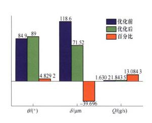
后的代理模型和多目标优化算法对该喷嘴关键几何结构参数进行优化设计,得到了一个在低压状态下雾化性能更佳的新结构喷嘴。采用计算流体力学(Computational fluid dynamics, CFD)对喷嘴进行流场分析,并用试验验证了 CFD 数值模拟的准确性。基于改进鲸鱼算法(Levy-WOA)优化的 Kriging 模型建立了雾化锥角、液膜厚度、质量流率的代理模型,研究了 4 个关键几何参数对雾化性能的影响规律。基于代理模型采用 MOGWO 算法进行多目标求解,得到了一个几何参数最优组合的喷嘴。研究结果表明:Levy-WOA 优化的 Kriging 代理模型具有更高的拟合精度和更低的预测误差,并能有效的预测 4 个关键几何参数对雾化性能的影响;优化设计的新喷嘴较原始喷嘴,雾化锥角增大了 4.829 2%,液膜厚度减小了 39.696 0%,质量流率提高了 13.084 3%;试验验证新喷嘴较原始喷嘴雾化锥角提高了 4%,为其他喷嘴的设计提供了一种新的可行性方法。
