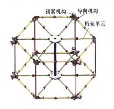
摘要:近年来,在轨服务技术日趋成熟,因此在空间技术研究领域在轨组装受到了较高的关注度。研究了一种大折展比高刚度索杆张拉式六棱柱组装单元及三爪式对接接口机构,并对其运动学及动力学特性进行了研究。首先,提出并设计了一种新型的空间结构组装单元和一种结构为三爪式的对接接口,进行在轨组装时可应用该接口。接着,分析了空间结构组装单元的运动学特性,验证了组装单元具有良好的展开与锁定功能。最终,通过对大型结构体模型进行有限元分析,发现了结构体的基频受到多个参数的影响,通过进一步的分析得到了具体的影响关系和灵敏度,为在轨组装空间大型结构体的设计奠定了基础。
