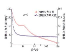
摘要:装配连接界面是承载和保障机械装备实现既定功能的 载体,其连接界面接触应力分布均匀性是影响机械装备磨 损、疲劳、裂纹的关键因素,对机械装备高性能服役具有"锚 定"作用。为改善连接界面接触应力分布均匀性,开展了材 料刚度优化设计研究。首先,以接触应力方差为目标函数, 以弹性模量为设计变量,基于渐进优化原理,构建了一种材 料刚度优化设计方法。然后,分别针对有无摩擦工况下两个典 型接触问题开展了材料刚度优化设计。结果表明,材料刚度优 化可大幅降低接触应力方差,验证了本方法在提升连接界面接 触应力分布均匀性上的有效性。进一步研究不同问题、不同摩 擦因数取值下摩擦行为对优化结果的影响,发现摩擦行为的影 响程度大小与问题边界、约束等情况密切相关。
