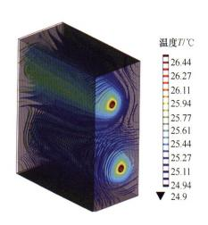
摘要:作为新型机器人一个重要的研究方向,微纳机器人在生物医疗领域取得了大量的成果,尤其是磁场驱动微纳机器人,由于其运动控制精准,不需与被控对象直接接触等特点被广泛应用于药物主动靶向递送中。近年来,由于缺乏对磁驱微纳机器人进行运动控制的同时又能给细胞组织提供合适环境的原位培养系统,严重制约了微纳机器人在促进细胞组织再生领域中的研究。为了实现磁场驱动微纳机器人实验过程中细胞组织的原位培养和监测,设计了一套针对磁驱微纳机器人的细胞原位培养系统,反向利用风冷散热器的原理实现系统的温度输出,并通过 COMSOL 软件进行了非等温流动仿真,其结果表明本套系统的加热模块的加热效果,加热执行装置的加热能力均满足需求,同时明确了培养箱的进出风口位置,而后通过温控实验验证了该套系统能够实现稳定的温度控制。该套原位培养系统的设计实用性强,适用性广,对于微纳机器人原位培养系统的研究具有一定的指导意义。
