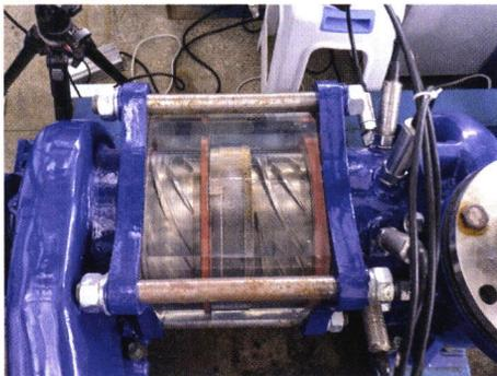
**摘要:** 叶片式气液混输泵是深海油气资源开采的核心装备,导叶对其输运性能影响较大,而混输泵导叶设计相关的研究很少。提出一种基于分段四次速度矩分布的叶片式气液混输泵导叶设计方法,利用三段四次函数控制导叶速度矩的分布规律,通过给定控制点流线长度及载荷等参数确定分布规律。将该设计方法应用到三级叶片式气液混输泵中,并选取轮毂前控制点载荷  $L_{1h}$ 、轮毂前后控制点载荷差  $\Delta L_h$ 、轮缘前控制点载荷  $L_{1s}$ 、轮缘前后控制点载荷差  $\Delta L_s$ 、前控制点流线长度  $m_1$ 、后控制点流线长度  $m_2$ 、起点载荷系数  $k_0$  等 7 个参数,对混输泵导叶进行 7 因素 3 水平的  $L_{18}(3^7)$  正交优化。完成混输泵导叶设计和优化后,泵效率在单相和两相工况下分别平均提升 6.73% 和 4.10%。优化前后的流场显示,导叶内流场低速区范围明显缩小,流动分离的范围和强度都受到了明显抑制。
