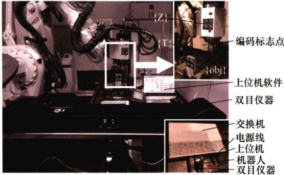
**摘要:** 机器人铣削加工是大型复杂构件的重要加工手段,然而由于机器人本体结构特点及零部件制造、安装等误差,使其在大行程运动过程中轨迹绝对精度较低,严重制约机器人铣削加工的应用工况。现有机器人精度的传感测量控制方法主要集中在基于视觉的定位误差预测和激光跟踪仪的轨迹误差测量等,前者难以考虑铣削轨迹误差,后者操作复杂且设备极其昂贵。为此,提出一种利用双目视觉系统跟踪测量的机器人铣削加工刀具端位置误差计算和加工误差补偿方法,实现机器人铣削加工误差的高效准确预测和补偿。其中通过训练粒子群算法(Particle swarm optimization, PSO)优化的BP神经网络建立了位姿相关的机器人加工刀具TCP位置误差预测模型,基于弦截法建立了位置误差迭代模型,制定了轨迹误差的综合补偿策略。试验结果表明机器人铣削加工最大切深误差从1.354 mm降低到0.244 mm,为机器人铣削加工工况扩展提供了理论和技术基础。
