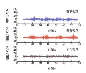
摘要: 高温合金蜂窝芯材料具有高比刚度、轻质和能量吸收 特性好等优异性能,被视为下一代高超声速飞行器热防护结 构极具潜力的材料。高速铣削是高温合金蜂窝芯零件成型过 程中重要的减材制造工艺,在蜂窝芯材料高速铣削时,蜂窝 芯材料面内刚度低且高温合金塑性好, 较小的切削力就会使 蜂窝壁产生较大的塑性变形,导致蜂窝芯加工精度较低、加 工损伤难以控制,对后续焊接、装配等工序产生不利影响。 基于有限元仿真对蜂窝壁切削材料去除机理进行了深入研 究,探索了铣削参数、刀具类型和铣削方式对铣削过程中铣 削力和加工损伤的影响。研究结果表明,蜂窝壁切入角是影 响蜂窝芯材料切削加工过程中瞬时应力分布和成屑机理的 关键性因素。得到了铣削参数、刀具类型和铣削方式对高温 合金蜂窝芯加工过程中加工损伤的影响规律。对于铣削参 数,过大的进给量会导致芯格变形等加工损伤,降低切削速 度会提高微小毛刺等加工损伤发生的频率;本文采用的三种 刀具的对比结果表明,立式铣刀加工质量最好。插铣方式会 产生明显的轴向冲击,而侧铣方式可以有效避免轴向冲击。 研究成果为高温合金蜂窝芯低损伤高性能加工提供了理论 依据和工艺技术储备。
