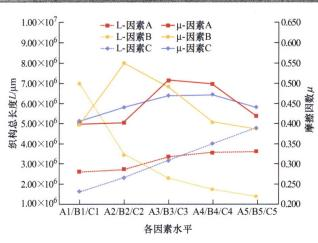
摘要:在再制造和设备运维阶段的拆卸过程中,过盈配合表面常因强烈的摩擦效应发生损伤。实验发现在配合界面上添加激光凹坑织构可有效降低拆卸损伤,且激光加工形成的熔融层增大了过盈配合面间的滑移阻力,有利于提升其服役承载能力。正交实验结果显示,相较于织构密度,织构图案尺寸与织构形状对界面滑移阻力的影响更为显著;等效圆直径100 μm、面密度 25%的椭圆织构具有良好的滑移阻力提升效果。在 60 MPa 到 150 MPa 的接触压力范围内,该类型织构表面的法向变形量大于无织构表面;且随着接触压力的增大,具有熔融层的织构表面的法向变形量更为稳定,其增幅远小于无熔融层织构表面和无织构表面。
