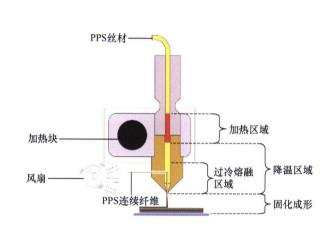
摘要:连续纤维增强复合材料 3D 打印工艺的出现,为复合材料构件低成本快速制造提供了一种新方法,为了充分利用 3D 打印连续纤维增强热塑性复合材料成形快,易成形复杂零部件的特点,结合自增强复合材料具有良好界面结合性,可循环利用的优势,分析了自增强复合材料 3D 打印技术研究的发展现状,提出一种利用过冷熔体成形连续纤维自增强复合材料的 3D 打印方法,设计了基于过冷的自增强复合材料熔融挤出打印喷头,采用聚苯硫醚(Polyphenylene sulfid, PPS)纤维与 PPS 树脂作为自增强复合材料原材料,探究自增强复合材料成形打印温度窗口、复合材料力学性能、微观界面结合性,以及对连续纤维自增强复合材料完全可回收性能研究分析。
