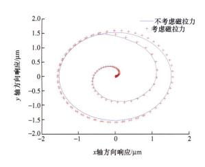
摘要:针对磁悬浮铣削电主轴在切削过程中因切屑进入刀具 容屑槽中而导致"刀具-主轴"系统质量变化,进而引起系 统回转精度不稳定的问题, 以变质量质点理论为依据建立 "切屑-刀具-主轴"系统的变质量动力学模型。分析系统的不 平衡质量变化时所引起的系统振动,进而导致磁悬浮轴承定 /转子间气隙磁场不均所产生不平衡磁拉力,并利用等效磁路 法建立不平衡磁拉力模型。利用 Riccati 传递矩阵法求解磁 悬浮铣削电主轴转子-刀具系统的稳态动力学模型,得到系 统的模态参数和初始偏心质量影响下的不平衡响应。考虑铣 削力、变质量力、切屑质量不平衡离心力和不平衡磁拉力等 因素,采用 Newmark-β 算法求解磁悬浮铣削电主轴转子-刀 具变质量系统的瞬态动力学模型。对系统从起动到切削过程 的动态响应进行仿真分析,结果表明,质量不平衡是影响磁 悬浮铣削电主轴转子-刀具系统稳态响应的主要因素; 在切 削过程中,变质量力是影响系统瞬态响应的主要因素;不平 衡磁拉力对系统响应的影响与系统的稳定性成负相关与系 统的振幅成正相关。
