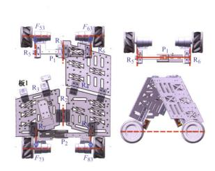
摘要:针对现有轮式机器人的本体相对固定无法适应复杂环境的问题,将自由度较少、折展比大的刚性折纸机构与高效的轮式运动相结合,提出一种新型可折展移动机器人机构,提升了移动机器人在复杂环境下的通过性能。对此机构折展原理进行分析,得到机器人三维尺寸与驱动角之间的关系,并通过建立简化模型,对动力学进行研究,得到不同位置的驱动力矩随驱动角的变化,从而得到最优驱动布置方案,之后通过运动协调算法研究,实现了机器人移动与折展协调运动,使其能够在复杂环境中高效运动。最后搭建物理样机以及控制系统,并通过试验验证机器人的移动及折展性能。结果表明,该可扩展移动机器人具有三维折展比大,运动灵活高效的优点,可通过切换姿态适应复杂路径,有望在探测、检测以及救援等工程领域得到应用。
