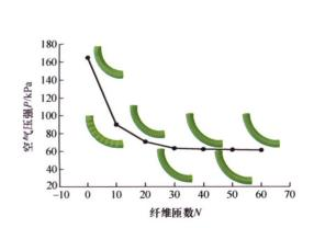
摘要:针对手部康复装置结构复杂、穿戴舒适性差、制作成本高等问题,提出了一种基于三维软体驱动器的新型手部康复装置。首先,根据手部功能运动范围分析,设计了具有三空腔结构和纤维增强结构的三维软体驱动器。其次,利用 Yeoh 模型、虚功原理和结构分析,建立了以空气压强、纤维匝数为输入量,弯曲角度为输出量的数学模型。然后,通过有限元分析,确定了纤维匝数和建议工作压强,降低了数学模型的计算量。最后,使用 3D 打印技术和硅胶材料完成了样机的制作。为了验证以上理论,在软体驱动器综合实验平台上进行了性能测试。结果表明,该软体驱动器的最大弯曲角度、指尖力和相对误差分别为 230°、1.08 N 和 25.04 %;该装置可以模仿常见手势,抓取日常生活用品,能够满足基本的手部康复训练。
