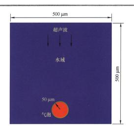
摘要:针对细微流道中的多相流调控问题,研究超声空化效应对微流道内固体颗粒运动特性的影响。利用 Fluent 有限元技术对空化气泡溃灭的过程进行模拟,得在超声声压作用于近壁区的气泡时,气泡凹陷、破壁、溃灭的演变过程,并对其周围流场的速度矢量分布进行研究,仿真结果显示,空化气泡溃灭能够产生射向壁面的高速微射流,其最大速度达到28 m/s,进而确定细微流场观测实验的最优参数;利用高速摄像机对细微流道中气泡的演变过程进行观测实验,并与仿真实验结果进行对照,观测实验结果表明,利用超声空化效应能够实现对固体颗粒向流道壁面运动的有效引导,为实现细微流道的流场调控、提高加工精度等问题提供理论支持。
