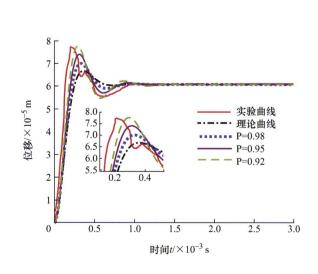
摘要:为进一步揭示超磁致伸缩致动器(Giant magnetostrictive actuator, GMA)系统非线性运动过程中的内在机理和动力学特征,基于分数阶微积分理论,将 GMA 动力学系统模型拓展至分数阶,建立含有分数阶阻尼的非线性 GMA 系统动力学方程,基于平均法分析系统主共振,得到系统的幅频响应方程;使用幂级数方法求解系统的数值解,通过 Matlab 数值模拟分析不同激励幅值和阻尼阶次对 GMA 系统的影响机理,从定性和定量的角度研究系统的分岔和混沌运动现象。结果表明:激励幅值和阻尼阶次对系统的始和混沌运动现象。结果表明:激励幅值和阻尼阶次对系统的确频特性有显著影响;阻尼阶次对系统的分岔和混沌行为影响较大;不同阻尼阶次下由激励幅值变化引起系统的动力学行为相似但混沌区域不同。该研究有助于更好地了解 GMA 系统动力学特性,对工程实践中控制 GMA 系统稳定运行提供新的视角。
