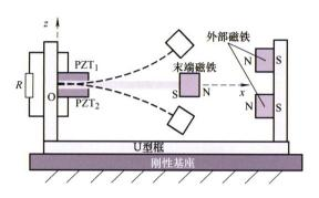
摘要: 提出一种基于线性放大与非线性磁力复合增强的三稳 态压电振动俘能器,实现在宽频范围内有效地采集低能轨道 振动能量。将质量块和弹簧组成的线性放大机构置于三稳态 压电俘能器与基座之间,调节线性放大机构与俘能器之间的 质量比和刚度比,使三稳态俘能器获得较大的输入动能从低 能轨道运动跳转到高能轨道运动,从而获得更高的输出性能 和更宽的工作频带。利用能量法建立了描述该复合压电振动 俘能器系统动态响应的非线性机电耦合数学模型; 采用动态 分岔图仿真研究了系统质量比和刚度比对压电俘能器动态 输出性能的影响及其能量俘获机理。实验验证了理论结果的 正确性。研究结果表明: 合理调节系统质量比和刚度比, 复 合俘能器可以在低能轨道振动时获得更宽的工作频带和更 高的发电能力。与传统刚性基座三稳态压电俘能器相比,实 验获得复合压电俘能器的阱间运动频率范围由 3~14 HZ 扩 大到 2~21.5 Hz,从低能轨道振动跳转到高能轨道振动所需 的激励加速度由 13.5 m/s<sup>2</sup> 降至 5.8 m/s<sup>2</sup>。
