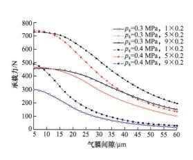
摘要:为了进一步探索和研究气浮静压润滑支承机理及气浮静压导轨承载性能,提出并研制了一种具有气浮静压润滑支承的精密二维运动平台。结合气浮静压导轨的物理模型建立了其笛卡儿坐标系下的控制方程,采用有限差分方法和流量平衡原理对其控制方程进行了离散差分推导,运用超松弛迭代以及二分快速寻找收敛区间法对其承载性能进行数值计算并开展了实验研究。结果表明:气浮静压导轨承载性能受节流器类型的影响比较显著,多节流孔节流器的承载性能明显优于单节流孔节流器;供气压力对气浮静压导轨承载性能影响显著,供气压力越高其承载性能越强;同等条件下气浮静压导轨组合形式承载性能均优于单独形式承载性能;气浮静压导轨的承载性能实验测试结果和数值计算结果具有较好的一致性,验证了数值计算的有效性。相关研究对推动和促进气浮静压轴承和导轨在精密运动机构和测量设备的研究和工程应用具有较好的借鉴和指导意义。
