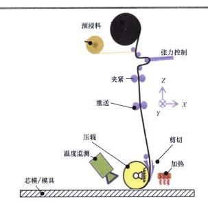
摘要:自动铺丝作为一种先进的复合材料自动化成型技术被广泛应用于航空航天等领域,其中采用变角度自动铺丝能够提升航空航天结构件的设计空间,对于提高构件整体力学性能具有重要的意义。但目前该技术的加工工艺并不成熟且在成型过程中不可避免产生制造缺陷,对构件的力学性能带来不利的影响。针对变角度自动铺丝成型过程中的制造缺陷特性及其主要影响因素进行综述,介绍了自动铺丝的工作原理及变角度铺丝的优势,分析了褶皱、间隙和重叠缺陷的形成机制及其对变刚度层合板力学性能的影响,深入探讨了变角度铺丝制造缺陷的影响因素类型及作用机理,并论述了制造缺陷的抑制方法,最后总结了现阶段变角度自动铺丝技术存在的不足,并对该技术的未来研究趋势进行了展望。
