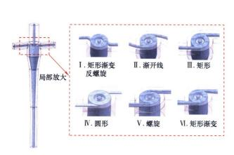
摘要: 针对超低进液量条件下油水旋流分离精度难以保障问 题,提出了一种微型水力旋流器结构。借助 3D 打印技术试 制微型水力旋流器样机,开展室内分离性能测试。基于 Plackett-Burman 设计对影响旋流器分离性能的主要结构参 数进行显著性筛选,得出了结构参数对底流口含油浓度影响 的显著性排序。结合最陡爬坡设计与响应曲面法,对显著性 较高的结构参数与底流口含油浓度间的数学关系模型进行 构建,基于最小二乘法对模型进行求解,确定出可提高分离 性能的结构参数最佳匹配方案。对初始微型水力旋流器结构 及优化结构开展不同分流比、处理量以及含油浓度条件下的 分离性能对比实验,实验得出优化后结构在溢流分流比为 30%, 处理量为 1.0 L/min, 含油浓度为 2%时质量效率最高, 达到 99.85%。优化后旋流器的分离性能明显高于初始结构, 实验结果验证了响应面设计优化方案的准确性,同时也证明 了设计的微型水力旋流器在超低进液量条件下油水分离的 高效性。
