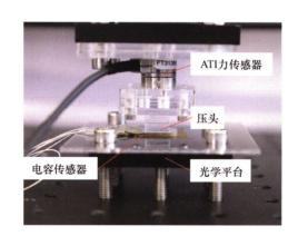
摘要: 软体电容传感器因其高柔顺性和高灵敏度等特征在人 机交互、可穿戴设备和软体机器人中有很好的应用前景,然 而电容检测很容易受到外界电磁场的干扰, 因此提出了一种 带屏蔽的软体电容传感器。为了能够同时检测法向压力和剪 切压力,设计了一种三电极的双电容结构,同时在传感器上 下表面添加屏蔽层来屏蔽外界电磁场干扰。为解决因屏蔽层 变形产生的寄生电容对检测电容的影响,提出了一种刚度分 层的方法,电极之间的电介质感知区域采用一种厚度仅约 0.6 mm 的硅胶海绵结构,而电极和屏蔽层之间采用实心硅 胶,从而保证按压传感器时感知区域的变形远大于屏蔽层。 实验结果表明,传感器可以同时检测法向压力和剪切压力的 变化, 法向灵敏度可达到 0.12 kPa-1, 单位剪切压强的电容 变化达 10 fF, 与不带屏蔽的传感器相比, 该传感器可将交 流高压(1400 V)电场引起的噪声减小到 9%。这种带屏蔽的传 感器在电吸附皮肤、软体机器人、可穿戴医疗设备等电磁干 扰较强的环境中具有潜在的应用价值。
