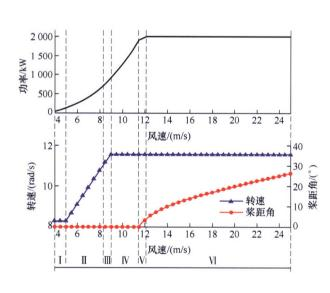
摘要:针对大型风力发电机组高维 SCADA 时序数据的工况识别问题,结合风电机组运行规律和 TICC 算法,提出一种自动分割聚类方法。从高维的 SCADA 数据中选取风速、转速和奖距角等少量特定参数作为初始分割聚类对象,分析特定参数的运行规律,确定风电机组理论的运行工况。选取一段特定参数的历史数据,利用 TICC 算法进行离线聚类分割,获得聚类的最优特征参数。将最优特征参数作为 TICC 算法的输入,对新的特定参数时间序列数据进行分类。最后根据特定参数时间序列的聚类结果,对未进行分割的 SCADA 时序数据进行聚类处理。选取某 2.5 MW 双馈风电机组的SCADA 时间序列数据对方法进行验证,同时将所提出的方法与 FCM 算法、GMM 算法、K-Means 算法进行对比研究。实例验证和对比研究表明,所提的聚类方法充分融合理论知识和 TICC 算法的优点,可高效处理高维 SCADA 聚类分割问题,同时保证聚类结果与理论分析结果一致性。
