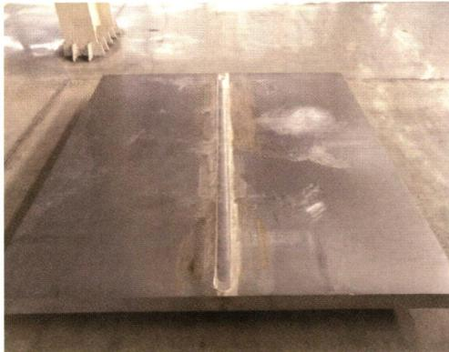
**摘要:** 目前,国内外对 100 mm 以上厚度的铝合金搅拌摩擦焊研究较少。针对 110 mm 厚 5083 铝合金(o 态)板材进行搅拌摩擦焊双面对接试验。焊后试样进行焊缝表面渗透检测、接头力学性能检测,对焊缝横截面、拉伸试样断口进行光学显微镜金相组织观测、扫描电镜观测。结果表明,试验所得焊接接头质量良好,焊缝表面无渗漏,焊缝内部没有孔洞、隧道等缺陷;试样抗拉伸强度平均值达到母材的 98% 以上,屈服强度平均值达到母材 90% 以上,伸长率平均值分别达到母材的 75.5% 和 82.4%,抗拉伸强度沿厚度方向呈现先降低后升高的“V”型趋势;焊缝横截面微观组织无缺陷,晶粒分布均匀并有 Mg 元素富集相析出;接头断裂机制为混合断裂,从焊缝表面至底部,断裂机制由韧性断裂向脆性断裂趋势发展。试验将 110 mm 厚铝合金搅拌摩擦焊接头沿厚度方向进行性能分析与研究。
