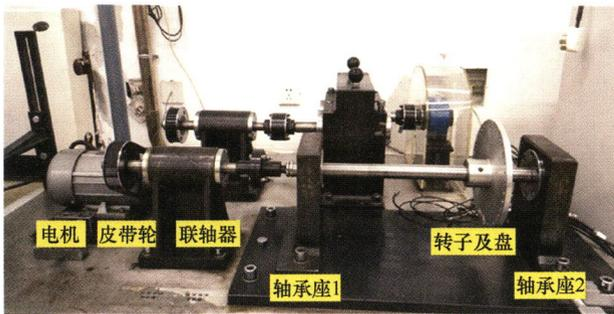
**摘要:** 旋转机械振动信号中的冲击特征通常代表着轴承损伤、齿轮损伤等常发故障的出现,为了准确提取信号中的冲击分量,提出一种基于改进群延迟估计的同步压缩变换时频分析方法。分析时间重分配同步压缩变换原型算法在处理实际强频变信号时的特性,发现其易导致明显的时频模糊问题。构建基于局部最大搜索算法的改进型经典群延迟估计方法,以克服 TSST 在分析强频变信号时带来的时频模糊问题,并在此基础上提出了群延迟自适应估计策略。形成一种基于改进群延迟估计的自适应同步压缩变换方法,在其基础上提出一种振动信号中脉冲特征提取方法。仿真信号和试验数据分析结果表明,该方法可较准确地提取出振动信号中的冲击特征,相较其他常用时频分析方法能够生成更为聚集的时频表示。
