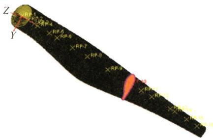
**摘要:** 叶片铺层设计为一个多参数、多目标的复杂耦合作用过程, 其性能主要取决于铺层参数。通过推导正轴刚度不变量和弯扭刚度矩阵间的关系, 构建层合板刚度等效模型与铺层顺序表征参数之间的数学关系, 实现铺层顺序的量化; 应用均匀试验设计、有限元分析和多元非线性回归法, 构建铺层参数和叶片性能间的耦合数学模型, 分析单参数和两两参数对叶片刚强度的影响; 为实现叶片刚强度的多目标优化, 应用层次分析法计算各目标函数权重, 建立叶片多目标优化数学模型; 基于模拟退火算法进行求解, 得到叶片综合性能最优的铺层参数组合为铺层角度  $45^\circ$ 、 $\pm x^\circ$  铺层厚度比例为 58%、铺层顺序为  $[\pm x^\circ / 0^\circ / 90^\circ / \pm x^\circ]_{7N}$ 。结果表明优化后叶片的最大位移和 Tsai-wu 失效因子分别降低了 2.79% 和 5.87%, 性能得以提高, 验证所提出多目标优化方法的有效性和可行性。
