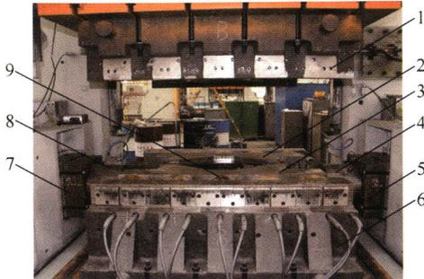
**摘要:** 胀压成形是制造大尺寸复杂形状汽车桥壳管件的新工艺, 成形性好、所需内压低, 但成形机理尚不明晰, 尚未有明确的内外压确定方法。简介胀压成形工艺, 分析了预成形管坯充液压制过程, 揭示出横截面小圆角及大圆弧区的成形机理, 推导出应力大小与内压、外压的表达式; 提出内压、外压的施加准则, 给出初始内压的计算公式及压制方式的数学表达式。针对某轴荷 10 t 桥壳管件的胀压成形过程进行了有限元模拟, 结果表明横截面小圆角、大圆弧区的应力状态及其变化趋势同理论分析一致, 揭示了小圆角两侧剪切应力的变化规律, 得到了最佳内压系数  $n_f$ 、压制系数  $k_s$ 。进行了桥壳管件胀压成形工程试验, 实测模具压制力及样件典型横截面的小圆角尺寸、大圆弧区壁厚, 相同条件下的有限元模拟与试验结果吻合, 最大偏差为 6.81%。
