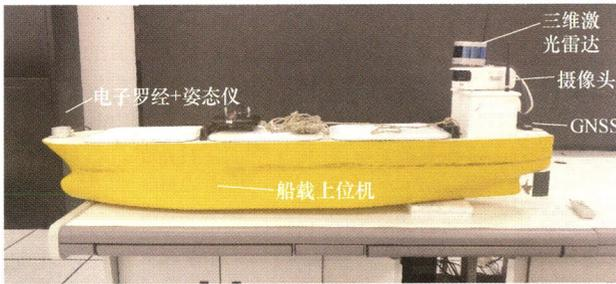
**摘要:** 为解决无人水面艇动态环境目标动态感知问题, 研究无人艇三维激光雷达目标实时识别系统。设计出无人艇三维激光雷达目标实时识别系统结构、硬件组成及数据通信协议。基于点云库(Point cloud library, PCL)、Qt 和 Visual Studio 平台开发了无人艇三维激光雷达目标实时识别系统软件, 实现了点云数据校正、实时处理、数据显示、状态输出、远程通信等功能。考虑到无人艇航行时周边环境障碍物三维激光点云分布特征, 将三维激光点云投影至多属性二维栅格进行表示, 利用八邻域算法实现了障碍物栅格的聚类, 解决了点云数据处理、目标分割、点云图像远程交互等关键技术。最后, 构建了室外水池环境下的无人艇三维激光雷达目标实时识别系统试验平台, 测试结果表明该系统能够可靠、准确识别无人艇周围 100 m 范围内的障碍目标。
