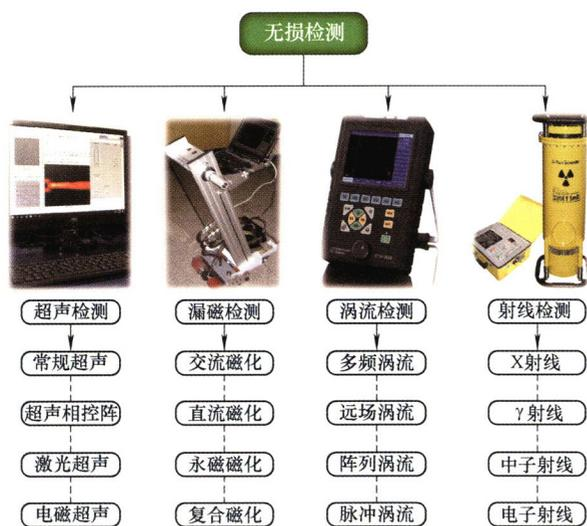
**摘要:** 核电站无损检测和状态监测对保障核电站安全稳定运行具有重要意义, 在役的不同类型的传感器也在发挥着其独特的作用。在基于新型传感技术的背景下, 对核电站的无损检测、状态监测和传感系统优化方法进行全面综述。研究并阐述常规超声、相控阵超声、激光超声和电磁超声等主流的超声检测诸多方法的同时, 也对其他检测无损检测手段进行对比分析。论述和总结基于光纤传感的新型核电站状态监测方法, 并讨论不同光纤材料在状态参数测量中的适用性。调研和概括大规模复杂核电站传感系统的优化和状态监测方法以及传感器的状态监测后端所涉及的信息分析手段, 并依据当今的先进工业互联网和人工智能技术对核电站的无损检测和状态监测未来发展给出设想。
