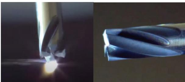
**摘要:** 随着航空航天、医药、汽车及电子工业的迅速发展,精密设备及微结构的制造需求逐年增加,微小孔( $d \leq 1\text{mm}$ )作为微结构中的常见难加工特征,其制造技术是限制相关领域装备发展的关键所在,因此,微小孔制造一直是机械加工行业的研究热点和难点,诸多学者从多种维度进行了相关研究,形成了丰硕的研究成果。由于微小孔钻削技术现阶段仍然是微小孔制造的核心工艺,而刀具性能则是保证微小孔钻削的核心要素,因此总结了近年来微钻刀具制造领域的重要技术进展,并从微钻刀具的材料选择、几何角度设计、制造工艺方法等角度展开叙述,介绍了最新的微钻刀具材料研究进展、解释了微钻刀具几何角度的设计方法,总结对比了国内外最新的微钻刀具制造技术,包括磨削、电火花磨削、高频激光加工技术等。由于PCD微钻具有优异的切削性能和极大的技术潜力,还重点介绍了PCD微钻制造技术及最新研究成果,并针对不同材料、工况下的微小孔钻削加工工艺参数进行了总结。
