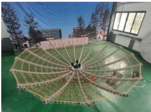
**摘要:** 针对现有单折伞状天线无法实现自动重复展收的问题,创新性地提出一种滚动轴承结合销轴、丝杠结合推板的展收机构,并进行了原理样机设计与验证。所提展收机构由单折肋、中心座、丝杠、丝杠螺母、上下推板、挡板、滚动轴承、销轴等组成。通过电机带动丝杠往复运动,推板上下移动,辐射肋根部在上下推板间滚动,辐射肋绕销轴转动,挡板限位锁定的方式,弥补了现有单折伞状天线的不足,创新性地实现了单折伞状天线辐射肋的重复展开与收拢。对辐射肋进行了运动学分析,得出了角度、角速度以及角加速度之间的转换关系。同时对反射体中的关键零部件进行了力学校验,以确保其可行性。设计并制作了4 m口径可重复展收单折伞状天线原理样机。通过原理样机重复展收试验,验证了所提创新机构的有效性。
