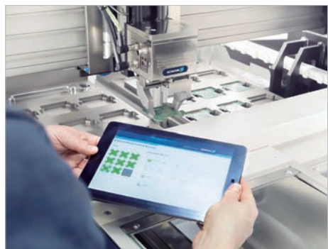
P13 智能机械手完成电子设备搬运与状态监控
