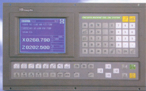
交流伺服驱动 CNC-60TA精度0.001 快速15米/分
