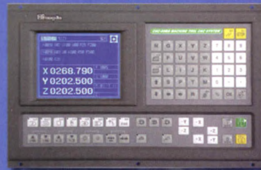
交流伺服驱动 CNC-60MA精度0.001快速15米/分
