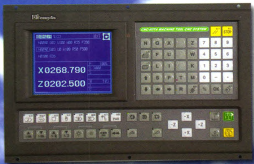
CNC-60TA精度0.001 快速15米/分
