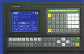
三相混合式驱动 CNC-70TA精度0.01 快速12米/分
