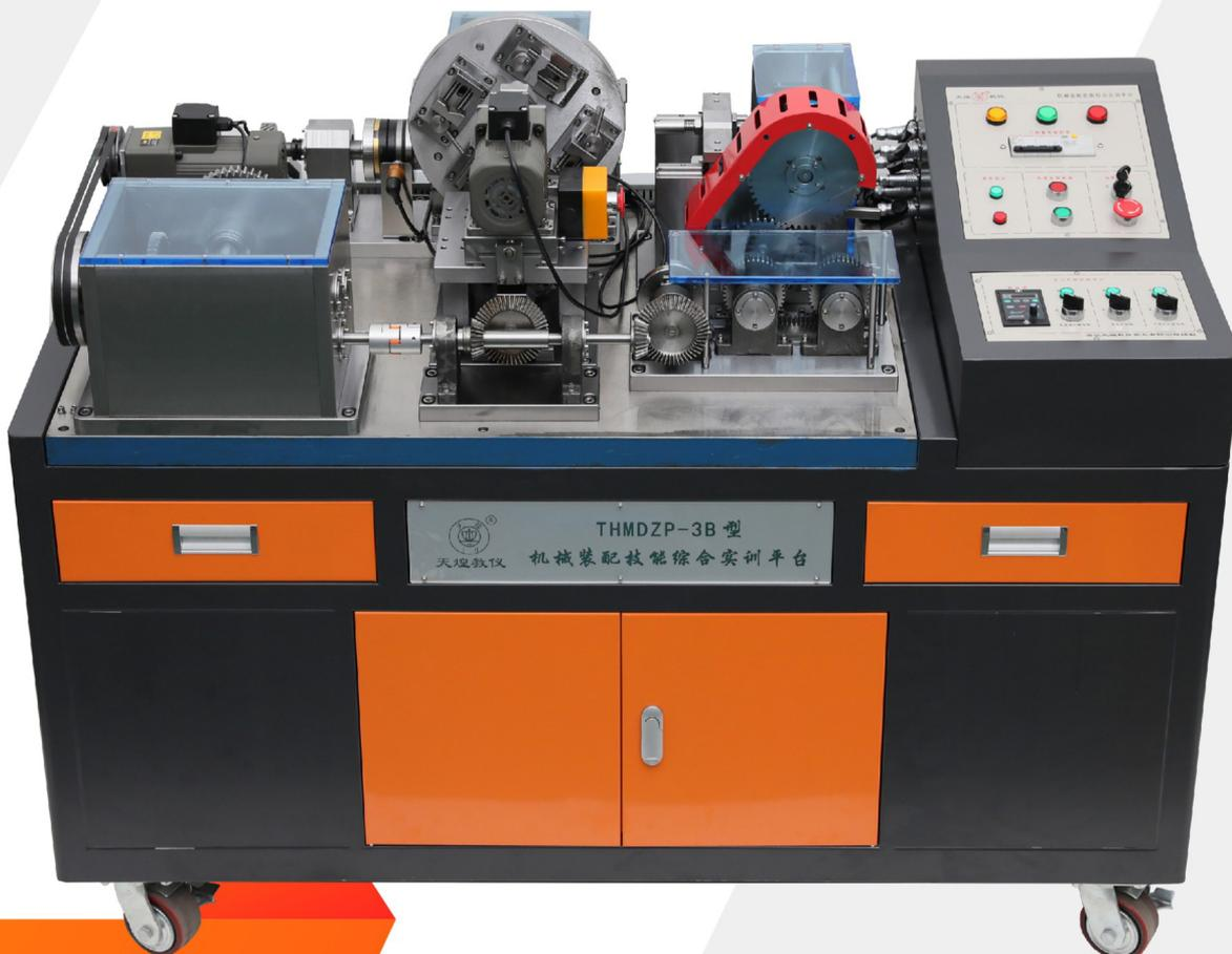
本实训平台依据机械类、机电类中等职业学校相关专业教学标准，紧密结合行业和企业需求而设计，该平台操作技能对接国家职业标准，贴合企业实际岗位能力要求，如《机械设备安装工国家职业标准》、《机修钳工》、《组合机床操作工国家职业标准》；平台以工业现场的典型任务为实践项目，以实现项目式教学，便于学生在“做中学、学中做”，具有可操作性和实用性。通过完成机械设备识图与装配工艺的编写，零部件装配及调整，组合机床、典型机床及机床部件的装配与调整，装配质量检验和设备的调试、运行与试加工等技能，提高学生综合职业能力，对中职加工制造类专业机械装配实训室建设起到示范和引领作用。
