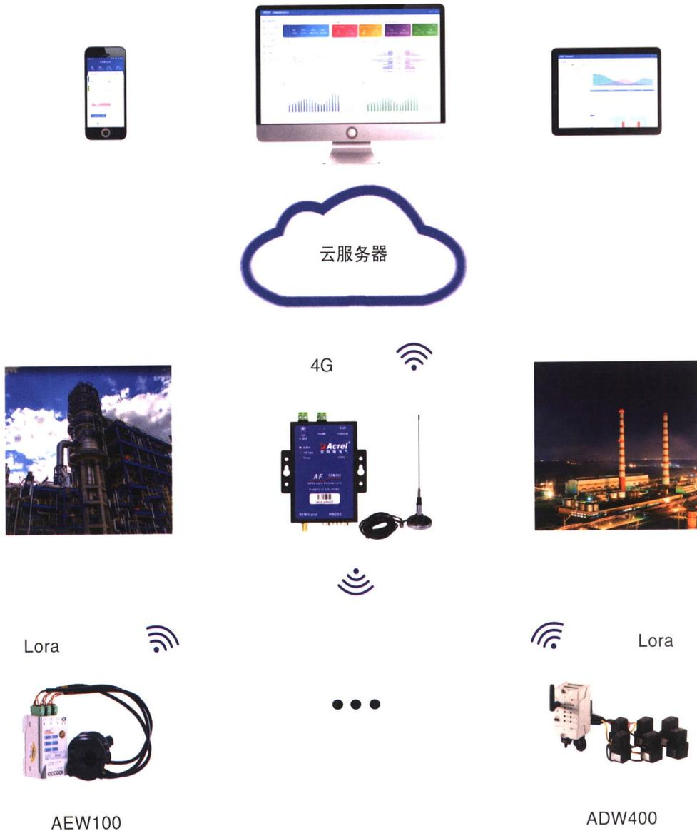
环保用电监管云平台通过采集排污企业总用电数据、产污设备用电数据和治污设备用电数据进行关联分析，及时发现环保设备使用异常情况，确保环保设备被正确使用，并支持数据上传政府平台用于环保申报，适用场合包括造纸、生物制药、石化、有色金属、工矿企业等等排污企业。
