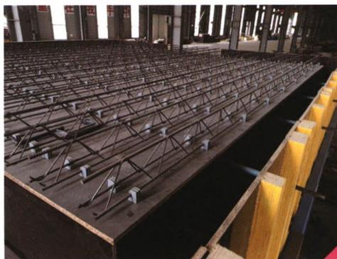
装配式可拆卸钢筋桁架楼承板
