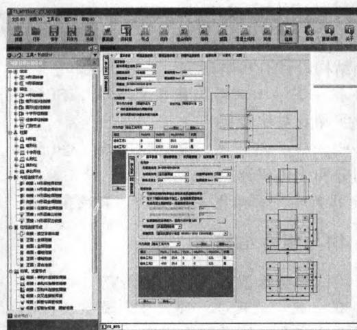
探索者钢结构构件计算软件TS-MTS
