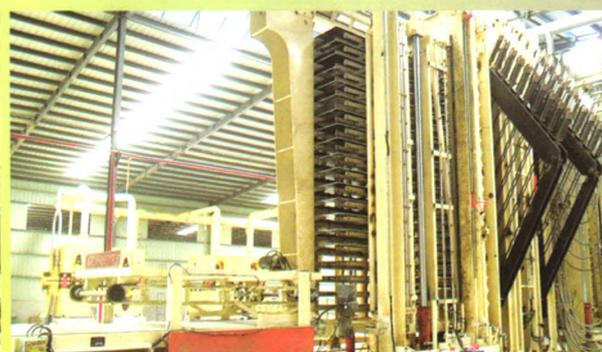
年产3-15万立方米单层热压刨花板生产线
