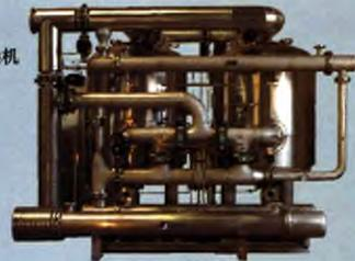
零气体损失加热再生吸附式干燥机
