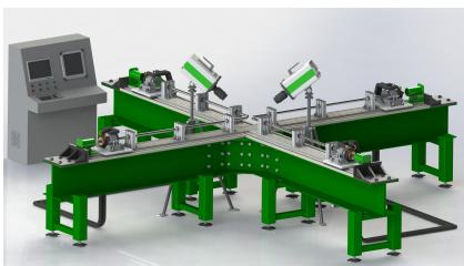
**【封面故事】**传统霍普金森杆通常只能研究单轴加载条件下材料的动力学行为, 电磁霍普金森杆实验技术的诞生为解决材料多轴动态力学性能开辟了新的方向。本期《电磁霍普金森杆实验技术及研究进展》一文中, 作者们系统介绍了电磁霍普金森杆实验技术在单轴单向/双向及动态双轴对称压缩/拉伸、复合材料的层间断裂、金属动态包辛格效应等领域的应用现状, 涵盖了实验研究, 理论分析及数值模拟等, 最后对该实验技术进行了展望。
