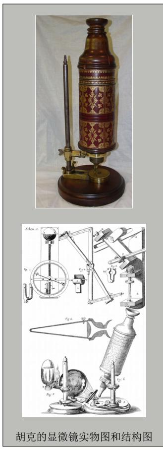
胡克的显微镜实物图和结构图
