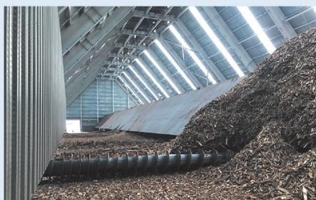
大容量封闭式行走螺旋料仓系统
