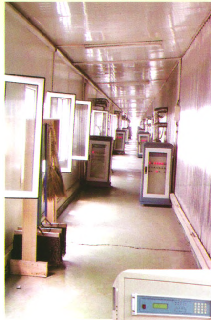
木材干燥及风机变频调速节能自动控制系统实验室样品
