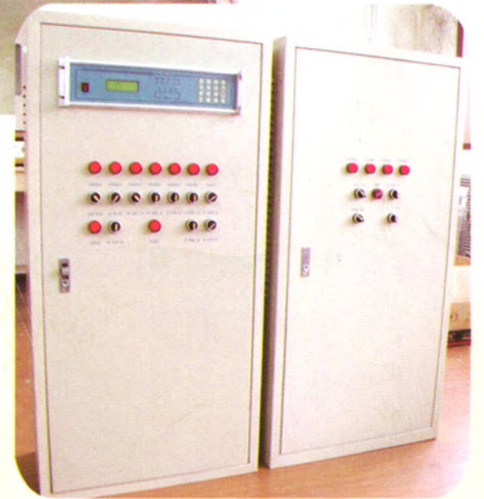
木材干燥及风机变频调速节能自动控制系统实验室样品
