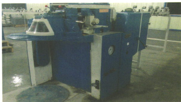
改造升级前的B423型机械控制式毛纺自调匀整针梳机
