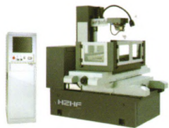
采用多次切割技术(中走丝线切割机)
