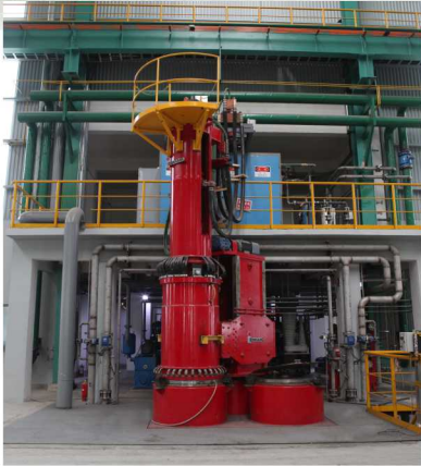
12吨真空自耗炉
