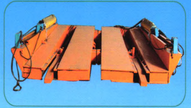
② ZAY-30型支架安装平台 用于综采工作面液压支架安装
