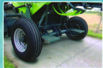
人性化的脚踏板设计， 便于机器的调节与维修
