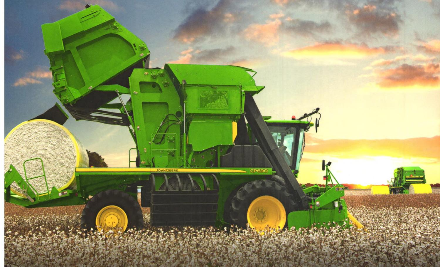
约翰迪尔 CP690 自走式打包摘棉机，一次完成田间采棉和机械打包，一档采摘速度高达 7.1 公里 / 小时更快的速度，更高的棉花采净率，节省您的工作时间。采用约翰迪尔发动机和约翰迪尔自动换挡变速箱，动力更强劲，性能更优异。
