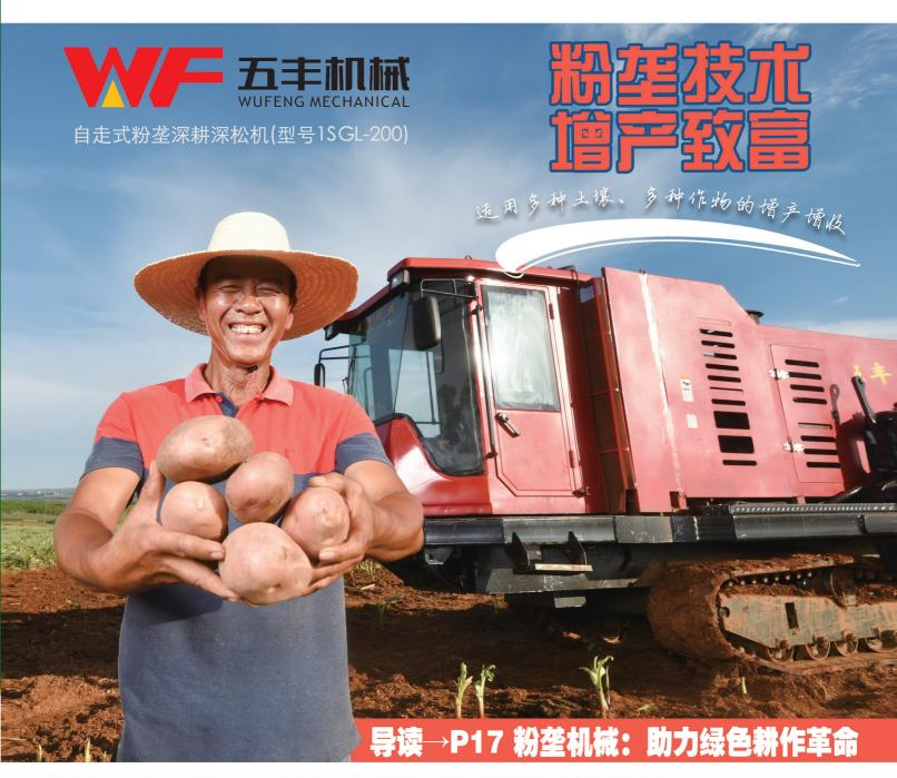
粉垄技术是一种全新的耕作技术,利用立式螺旋钻头,垂直深入切割土壤,打破犁底层并使土壤均匀粉碎。经粉垄耕作的土壤,在全国二十多个省区几十种农作物对比试验,在相同条件下均比传统耕作方法增产效果明显,适用多种土壤以及包括小麦、玉米、大豆等多种作物的增产增收,而且作物质量明显提高,同时兼具保水淡盐等功效。
