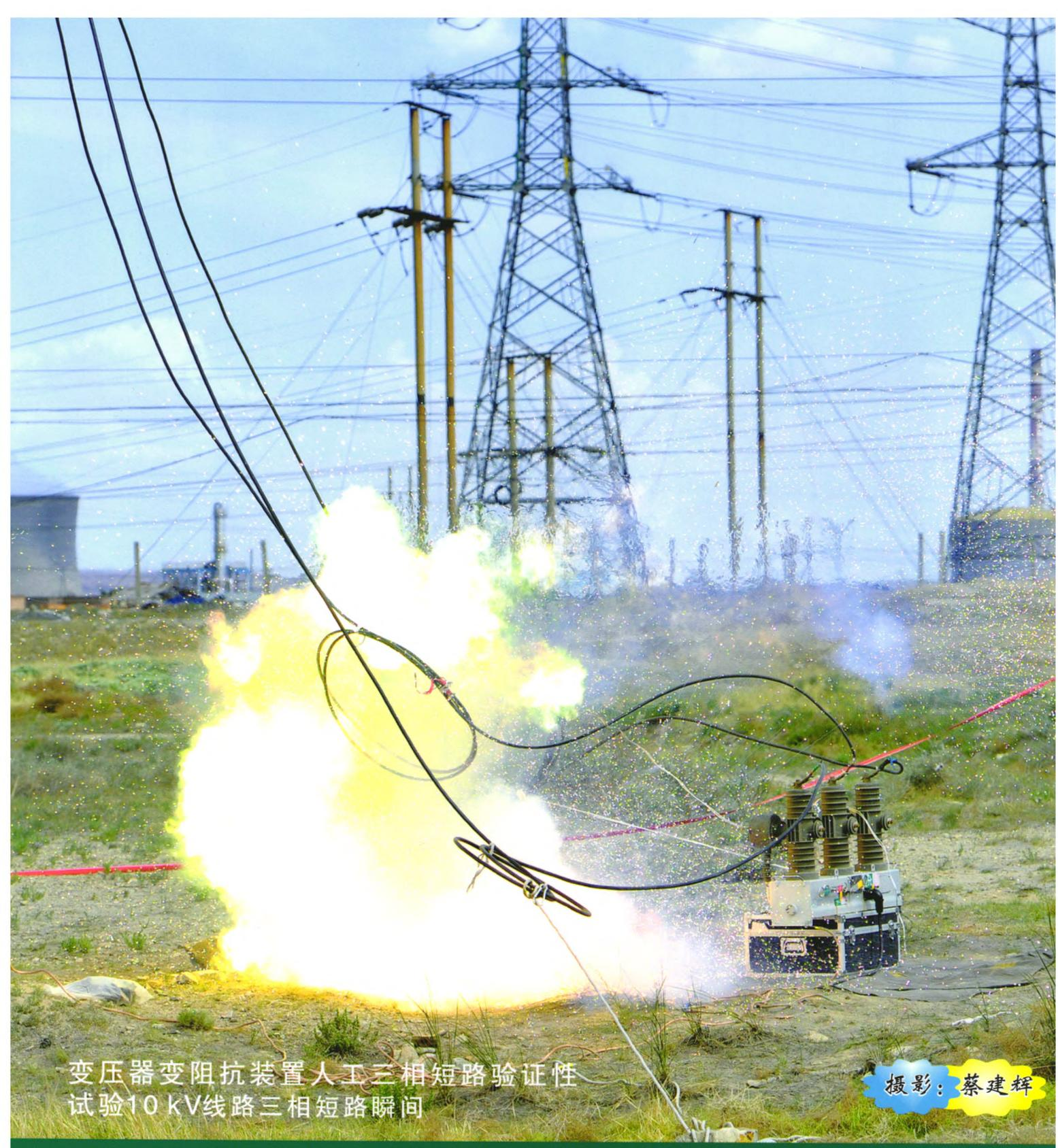
变压器变阻抗装置人工三相短路验证性
