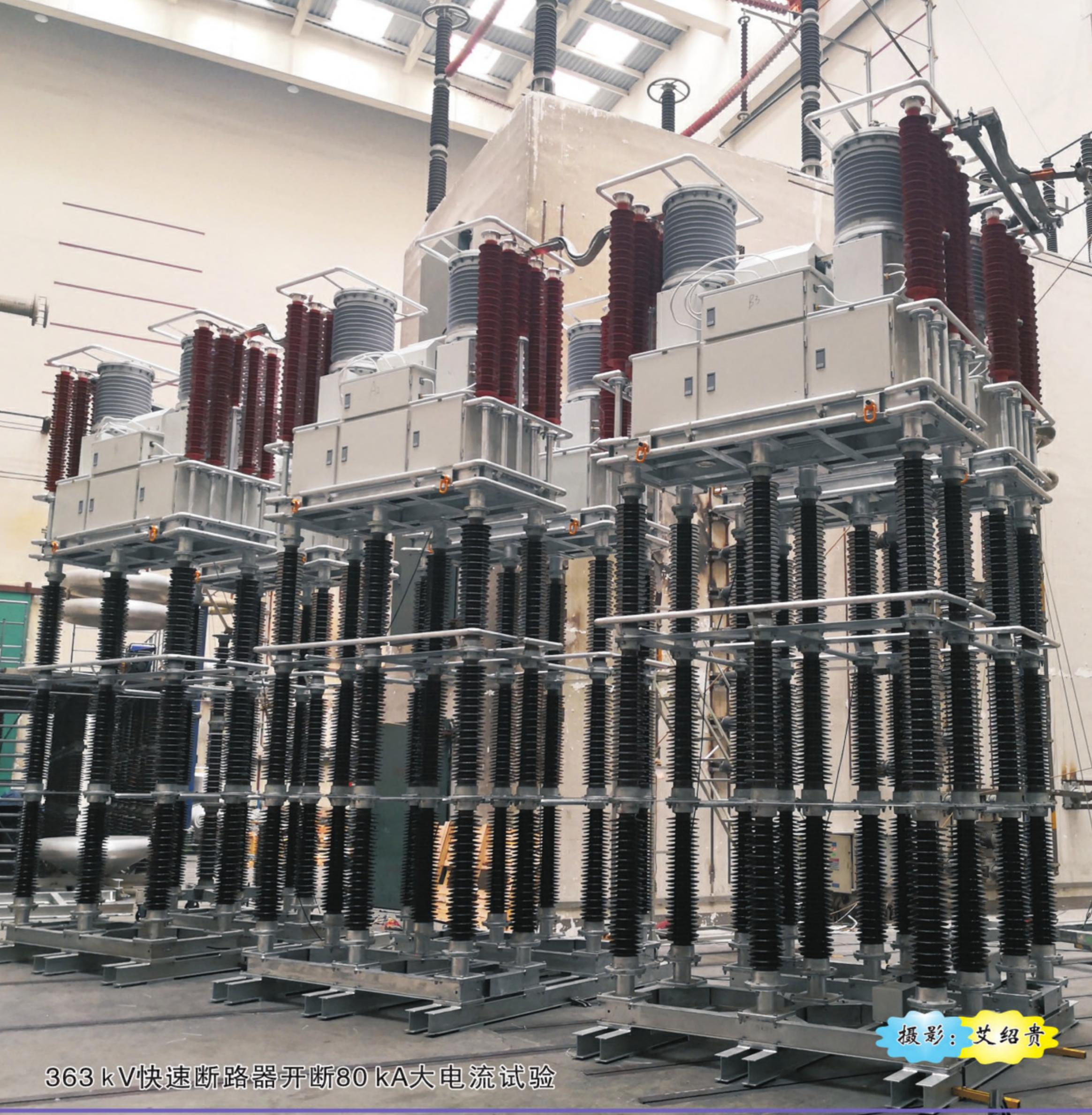
363 kV快速断路器开断80 kA大电流试验
