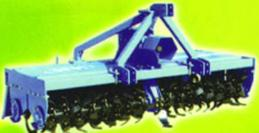
1GND-200型双轴多用旋耕机
