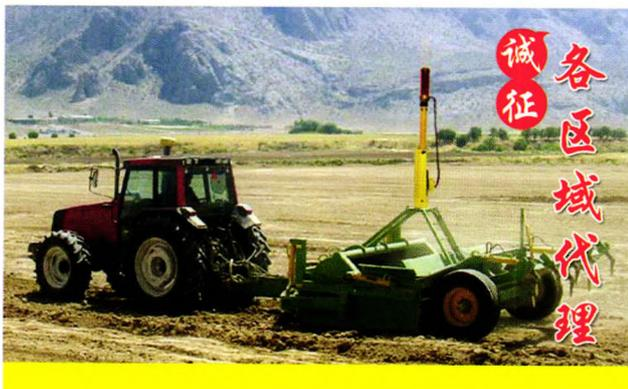
德国MOBA公司是专业从事用于各类机械找平自动控制系统研发公司，MOBA农业激光平地系统是一套精准的通过手动及自动高度调节的激光控制系统。基于CAN技术的MOBA模块化系统保证了未来升级的灵活性。
