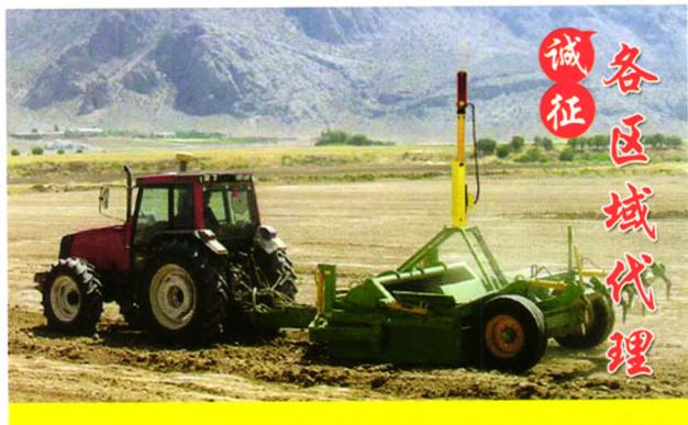
德国MOBA公司专业从事用于各类机械找平自动控制系统研发公司，MOBA农业激光平地系统是一套精准的通过手动及自动高度调节的激光控制系统。基于CAN技术的MOBA模块化系统保证了未来升级的灵活性。
