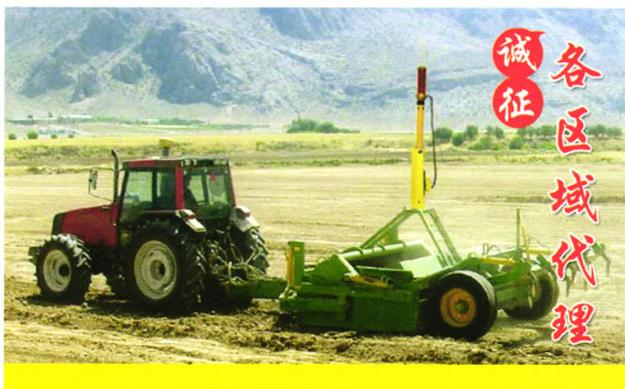
德国MOBA公司是专业从事用于各类机械找平自动控制系统的研发公司，MOBA农业激光平地系统是一套精准的通过手动及自动高度调节的激光控制系统。基于CAN技术的MOBA模块化系统保证了未来升级的灵活性。
