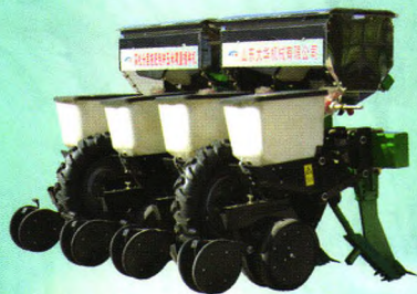
2BM YFZS-4型玉米深松全层施肥高效精密播种机
