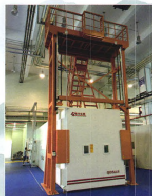
步入式温度湿度高度试验箱
