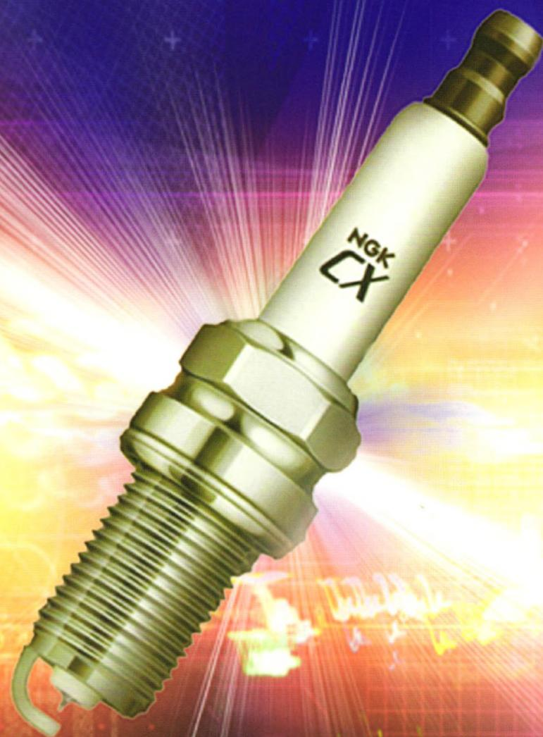
**火花塞** (spark plugs)，俗称火嘴，它的作用是把高压导线送来的脉冲高压电放电，击穿火花塞两电极间空气，产生电火花以此引燃气缸内的混合气体。火花塞的功用是将上万伏的高压电引入燃烧室，并产生电火花点燃混合气，与点火系统和供油系统配合使发动机作功，在很大程度上共同决定着发动机的性能。
