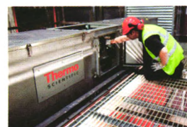
SIPRO 铝热轧多通道凸度仪
