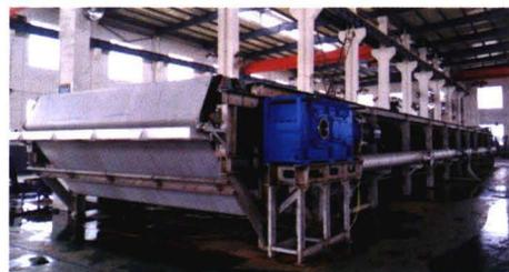
● 保温设计、波浪型真空抽滤箱导流槽设计、多真空抽滤箱设计，使滤液不易结垢。
