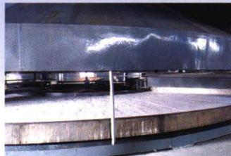
★ 目前我公司2台180m<sup>2</sup>氧化铝转盘真空过滤机分别在山西信发化工有限公司、山西华兴铝业有限公司现场使用 (用于年产超过100万吨氧化铝生产线)
