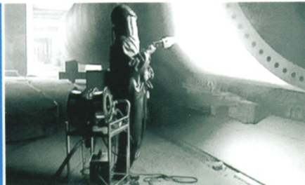
电弧喷涂机在喷涂西门子风电塔筒
