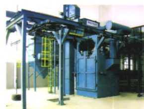
Q48单行程系列吊链步进抛丸清理机
