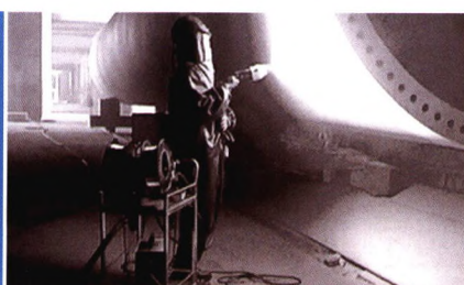
电弧喷涂机在喷涂西门子风电塔筒
