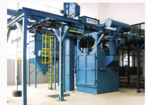
Q48单行程系列吊链步进抛丸清理机
