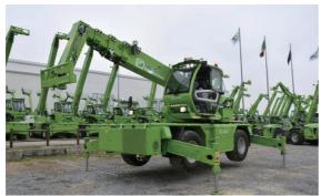
2022 年 4 月 21 日,意大利伸縮臂叉车制造商 Merlo (默罗) 发布其全系列的 Roto 旋转伸缩臂叉车,该产品增加了可插入式电源系统版本。以减少工作环境 中的排放、噪音和燃料为主要目标,Merlo 在Roto 伸缩臂叉车系列中添加了一个电动机,可以控制其所有运动,除了前进和后退。
