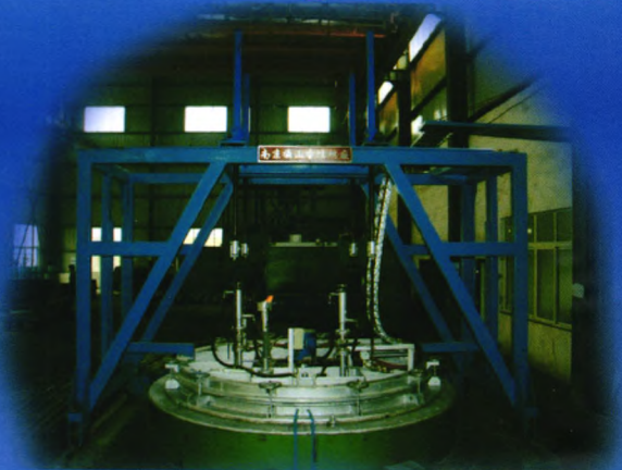
大型井式气体渗碳炉
