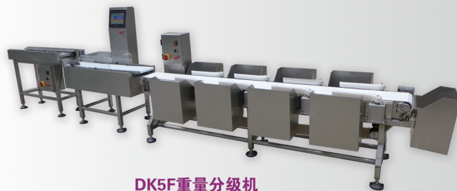
DK5F 重量分级机 DK5F weight classifier
