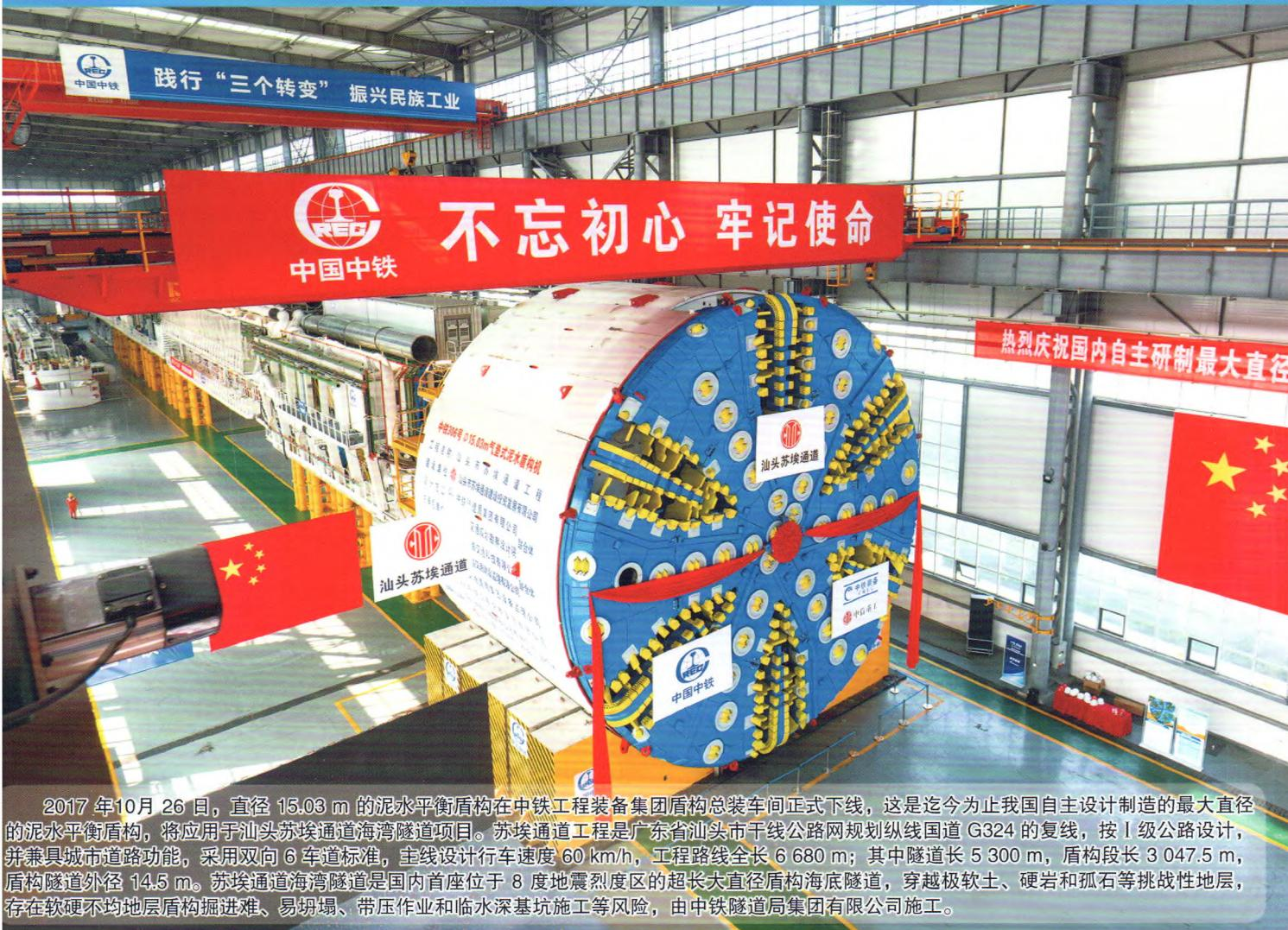
2017年10月26日，直径15.03m的泥水平衡盾构在中铁工程装备集团盾构总装车间正式下线，这是迄今为止我国自主设计制造的最大直径的泥水平衡盾构，将应用于汕头苏埃通道海湾隧道项目。苏埃通道工程是广东省汕头市干线公路网规划纵线国道G324的复线，按I级公路设计，并兼具城市道路功能，采用双向6车道标准，主线设计行车速度60km/h，工程路线全长6680m；其中隧道长5300m，盾构段长3047.5m，盾构隧道外径14.5m。苏埃通道海湾隧道是国内首座位于8度地震烈度区的超长大直径盾构海底隧道，穿越极软土、硬岩和孤石等挑战性地层，存在软硬不均地层盾构掘进难、易坍塌、带压作业和临水深基坑施工等风险，由中铁隧道局集团有限公司施工。
