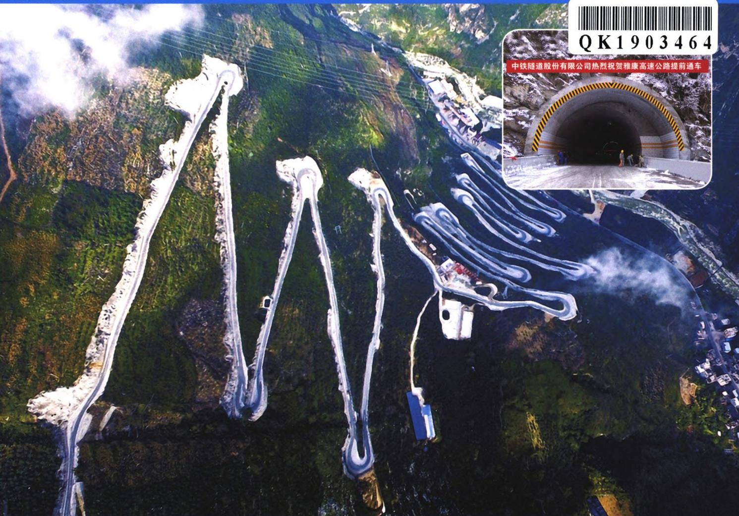
雅安至康定高速公路桥隧比高达 82%，是目前四川省乃至全国桥隧比最高、施工难度最大的高速公路之一。作为首条从四川盆地向青藏高原快速攀升的高速公路，项目建设面临“地形地质条件极其复杂、气候条件极其恶劣、生态环境极其脆弱、工程施工极其困难”的严峻挑战，被院士和专家比喻为攀登公路建设的珠穆朗玛峰。由中铁隧道股份有限公司承建的大杠山隧道，全长 4 730 m，隧道洞口在海拔 2 016 m 的悬崖上，是全线的控制性工程之一。为了到达隧道斜井的施工入口，解决“上得去、下得来”的问题，项目耗时一年半修建了一条长 9 km、爬升 600 m 的“之”字形 24 道拐施工便道，为隧道施工开创了条件。在施工过程中，先后克服了涌水、岩爆等不良地质条件和极其困难的施工条件，确保了 2018 年底全线顺利通车。通过雅康高速公路的修建，为我国西南山区公路、铁路建设积累了宝贵经验。
