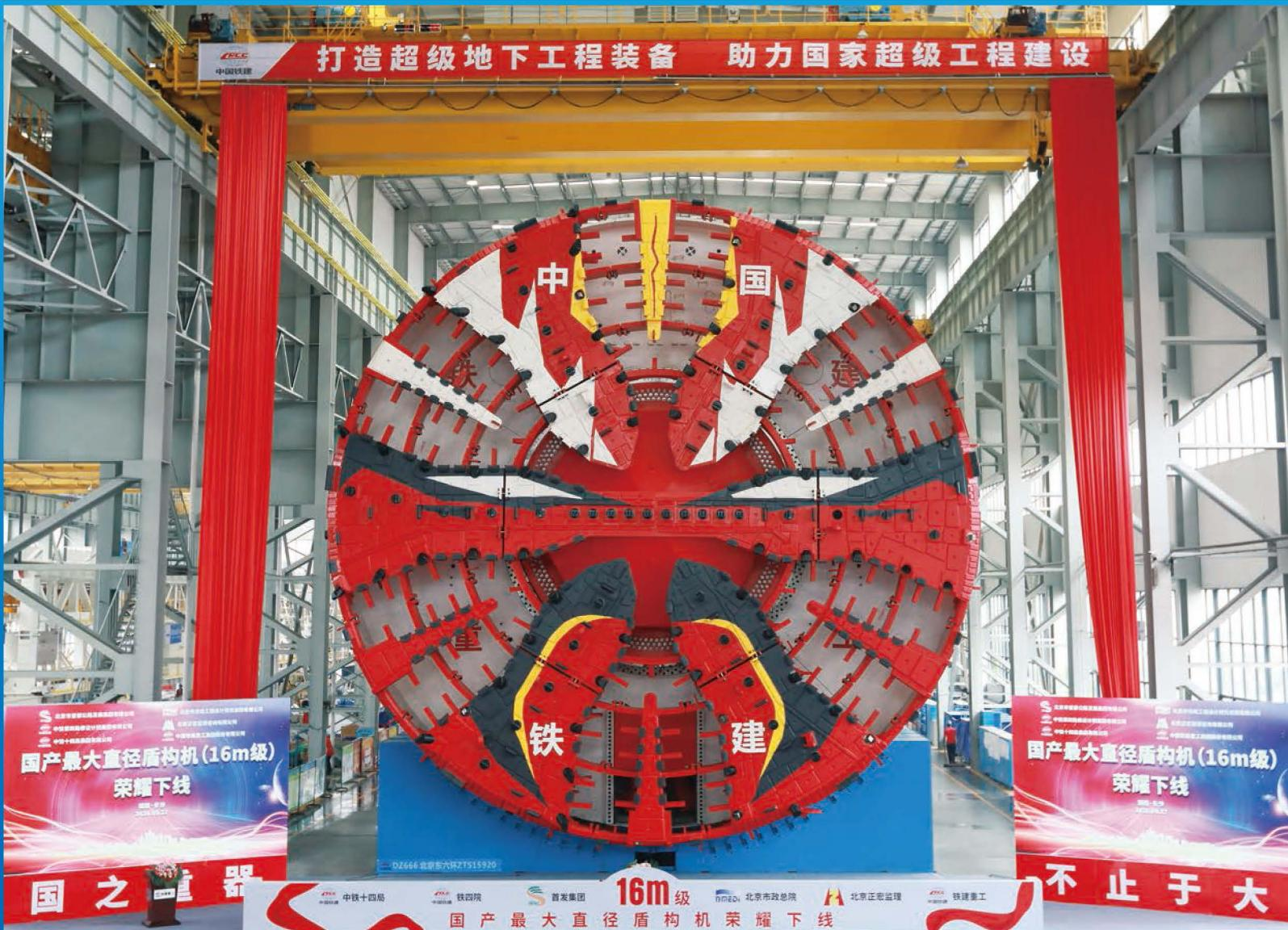
2020年9月27日，最大开挖直径达16.07 m的超大直径盾构“京华号”在中国铁建重工集团长沙第一产业园下线。该盾构整机长150 m，总质量4 300 t，是我国研制的最大直径盾构。配置了常压换刀、伸缩主驱动、高效大功率泥水环流系统，采用超大直径重载管片高效倒运及拼装、高精度开挖面气液独立平衡控制等多项核心技术；同时，创新搭载了管环收敛测量、管环平整度检测、管环选型、自动盾尾间隙测量、同步双液注浆、三通闭塞器换管等系统装置。该设备由铁建重工、中铁十四局联合研制，将用于北京东六环改造工程。
