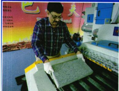
PM-720 全自动抛毛机 PM-720 Automatic Blasting Machine
