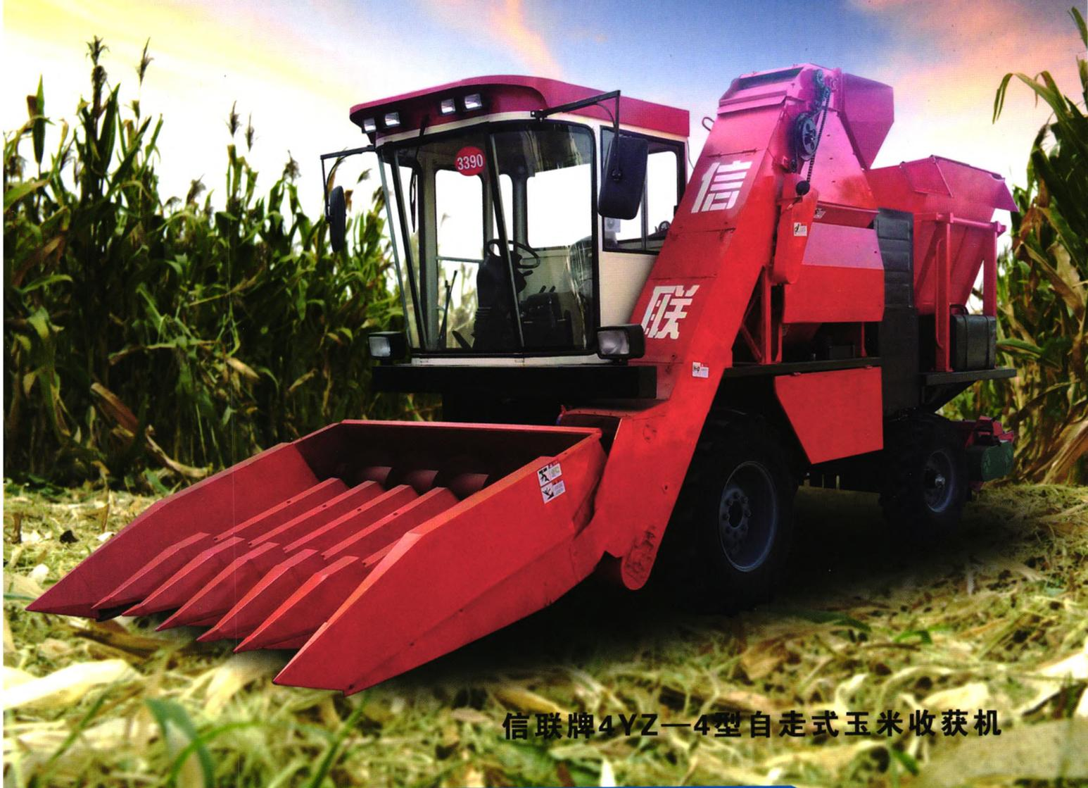
信联牌4YZ—4型自走式玉米收获机
